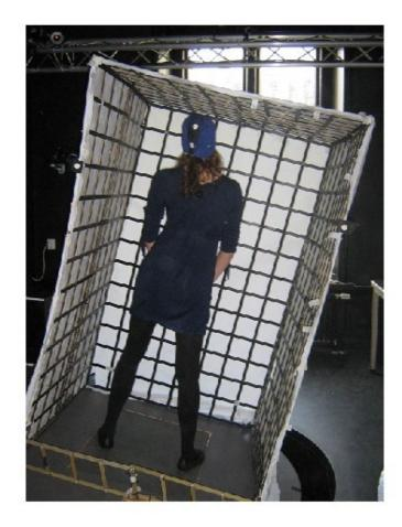
I soggetti indossavano uno speciale cappello nel quale erano stati fissati dei marcatori ottici. Lo stesso tipo di marcatori erano stati fissati anche sulla piattaforma, per determinare la posizione relativa della testa e della piattaforma.
